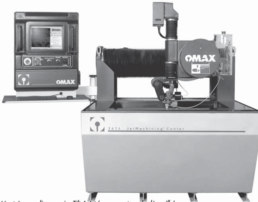
Montrée avec l'accessoire Tilt A Jet (compensateur de dépouille)
